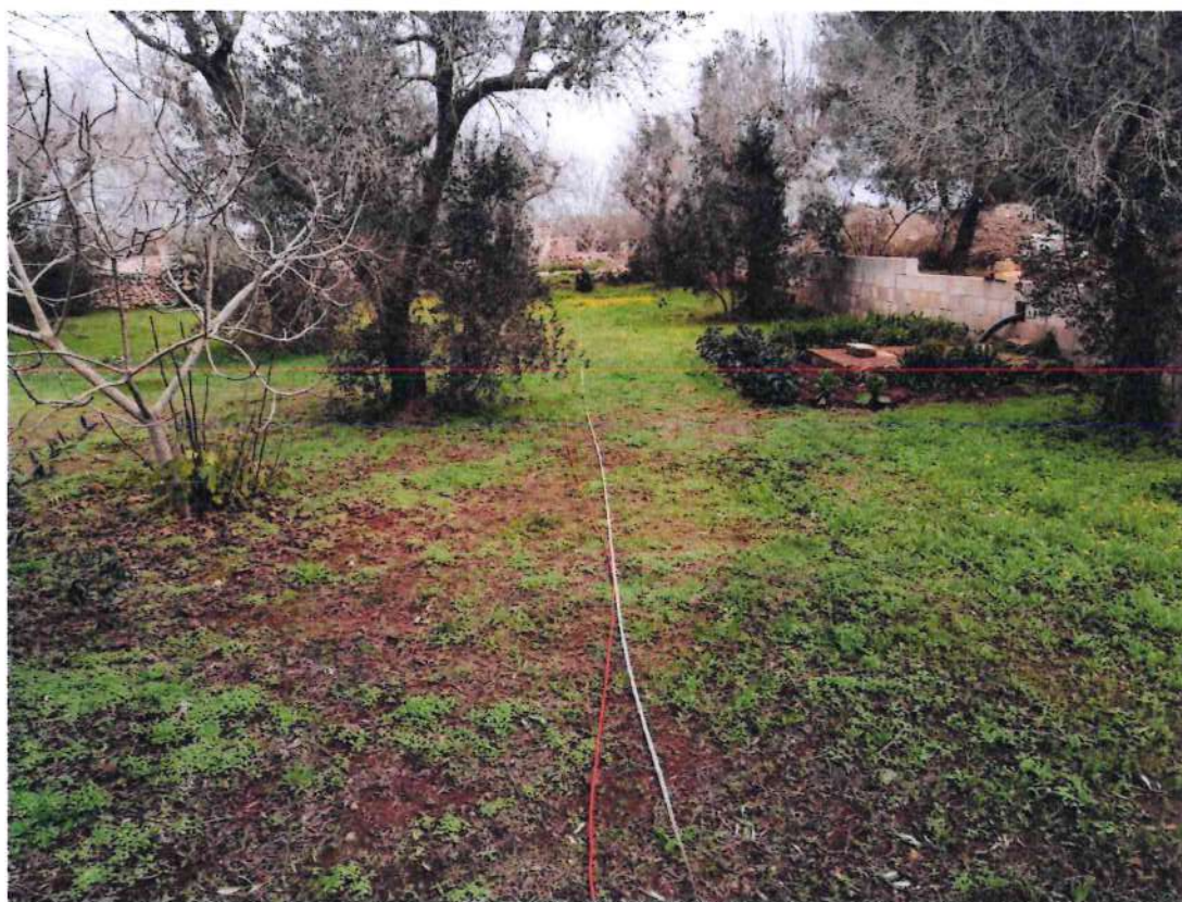
Profilo sismico a rifrazione n. 3 in Andrano e Masw n. 2 sullo stesso stendimento
