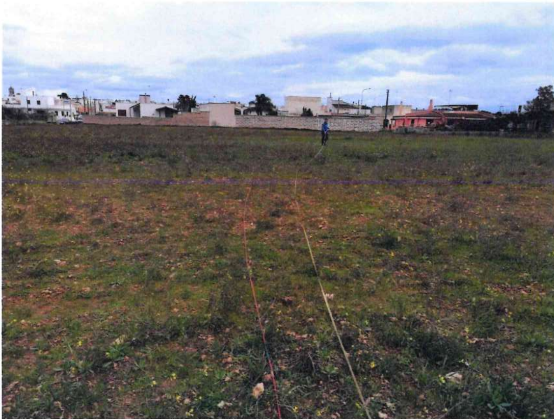
Profilo sismico a rifrazione n. 2 in Castiglione e Masw n. 1 sullo stesso stendimento
